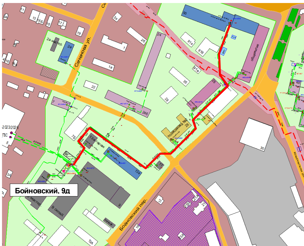
Рисунок 1.23 – Результат гидравлического расчета - расчетный путь теплоносителя от Бойновский, 9д до ПТ-Б.Печер, 93 МВт
